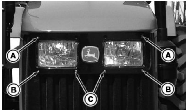
A—前大灯调整螺钉（2个） B—前大灯调整螺钉（2个）
