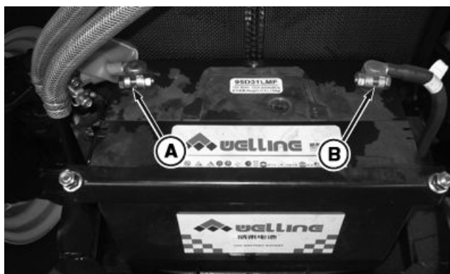
A—正极（+）电瓶接线端
