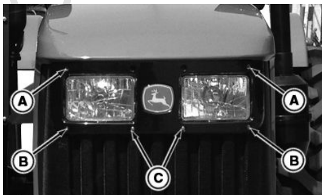
A—前大灯调整螺钉（2个） B—前大灯调整螺钉（2个）
