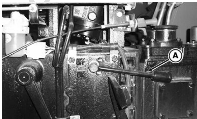
A—机械前轮驱动控制杆
