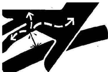
定期检查液压软管是否有泄露或任何其它磨损或损坏情况。用纸板检查泄漏情况。注意保护手和身体，防止高压液体的伤害。
