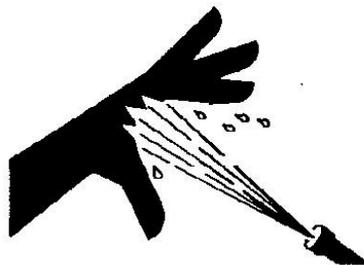
燃油管路中的高压燃油可造成严重伤害事故，不得断开或尝试维修燃油管线、传感器或任何介于高压燃油泵和带高压共轨（HPCR）燃油系统发动机喷嘴间的其它组件。
