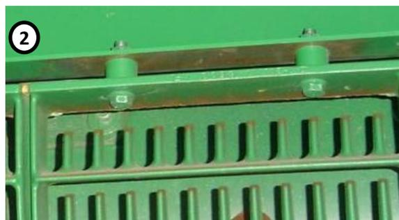
出厂时，隔套安装在存放位置（1）。隔套可用于玉米收获作业中，减少玉米芯碎块进入粮箱样品中。
